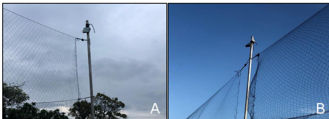
Figura 2.31: A: aplicação da metodologia de ponto fixo durante a campanha de diagnóstico da Usina Fotovoltaica Paineira. B: gravador modelo AudioMoth 1.2.0 instalado em haste de sustentação das redes de neblina.
