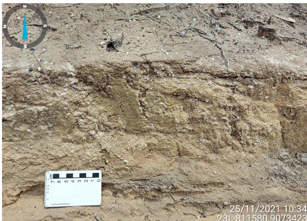
Figura 2.14: Perfil de Neossolo Quartzarênico, com até 20 cm de espessura, em contato com siltito.
