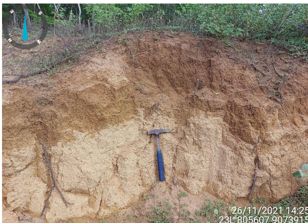
Figura 2.15: Perfil de Neossolo Litólico com sequência de horizonte A-R, com até 40 cm de espessura, em contato com depósitos sedimentares.
