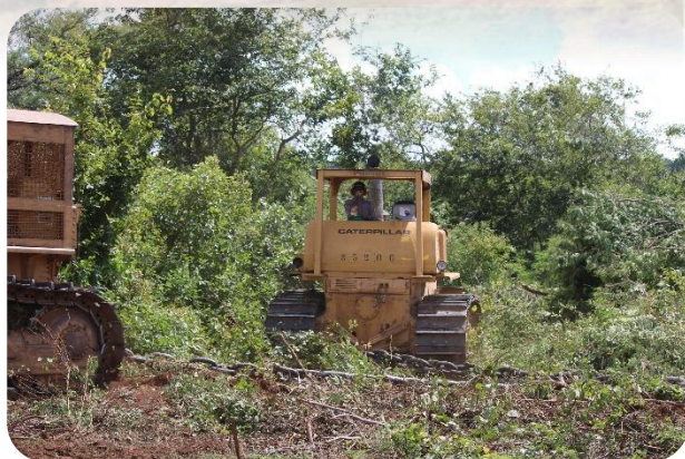
Corrente acoplada aos tratores para derrubada das árvores.
