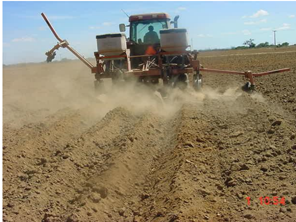
Foto 5-21- Operação de abertura de sulco, adubação e instalação dos tubos gotejadores.
