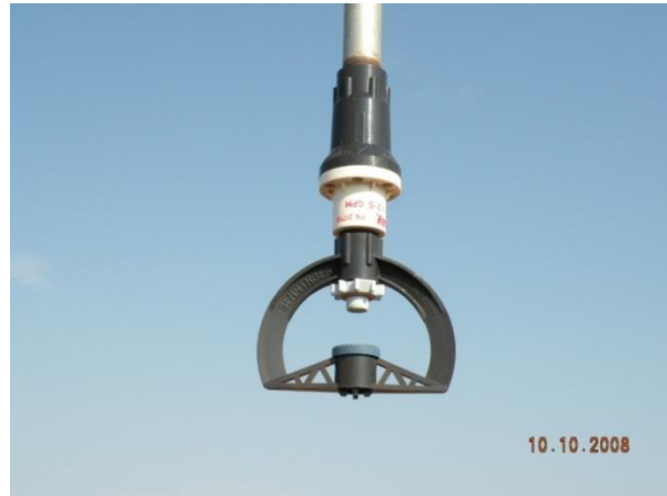
Foto 5-18 - Vista do regulador de pressão e do difusor.
