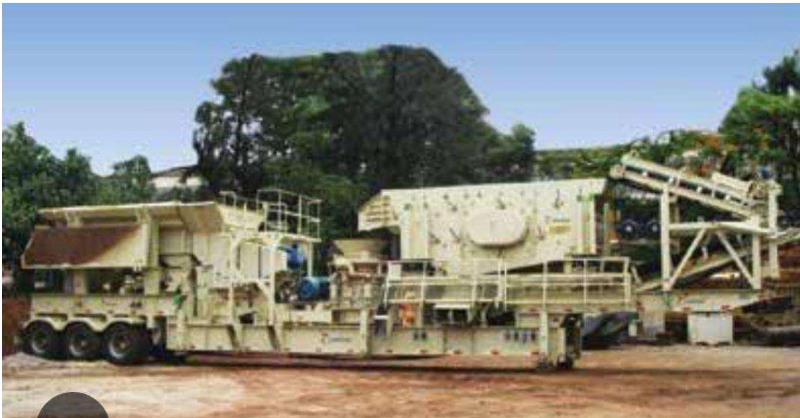
Foto 01 Planta móvel Metso NW96 + britador cônico HP200
