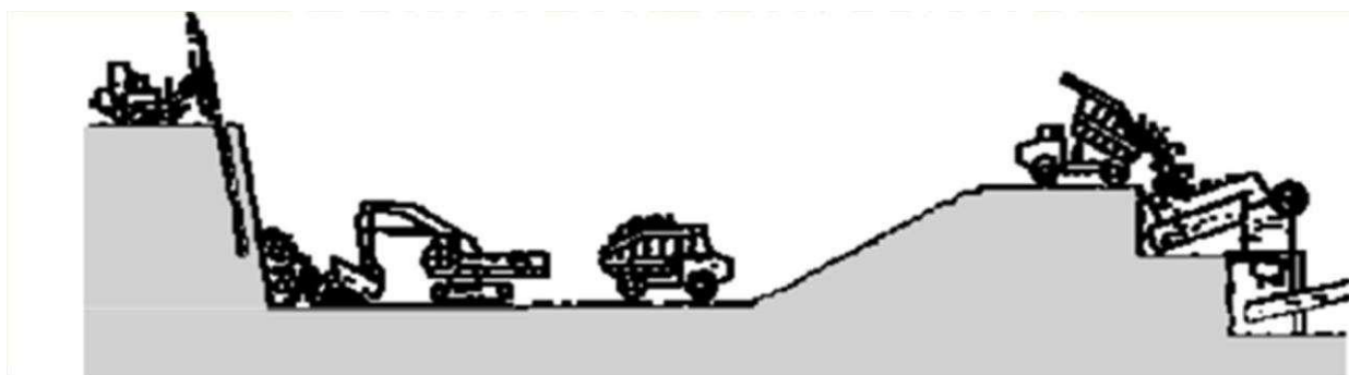
Figura 1 - sistema carregadeira frontal/caminhão
