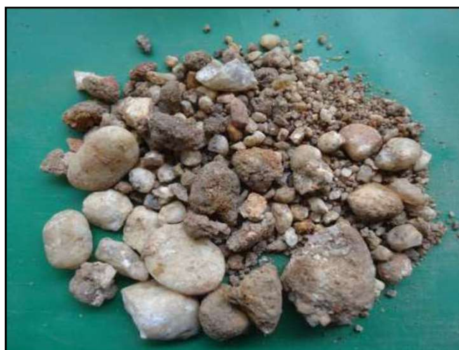
Figura 75. SP-04 Amostra 04/09 – Profundidade: 1,00 a 1,45m Classificação do Material: Silte arenoso, pouco a medianamente argiloso, pouco compacto, a fofo, com pedregulho de seixo de cor marrom pouco escuro. (Fonte: PCA Engenharia, 2018).
