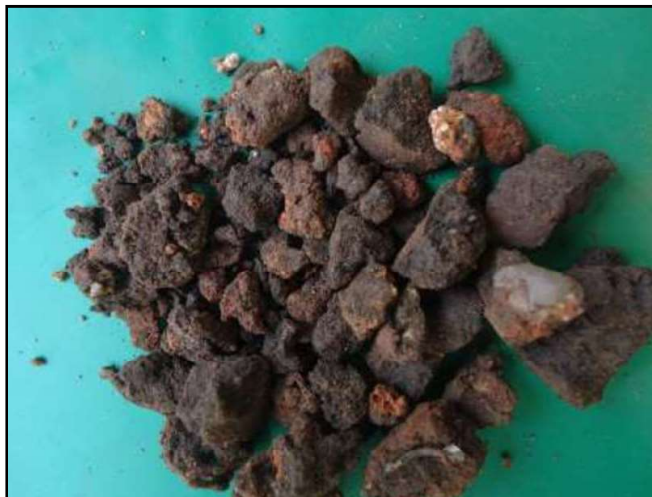
Figura 68: SP-03 Amostra 04/07 – Profundidade: 2,00 a 2,45m Classificação do Material: Silte arenoso, pouco a medianamente argiloso, medianamente compacto, com pedaços de pedras, de cor pouco escuro. (Fonte: PCA Engenharia, 2018).
