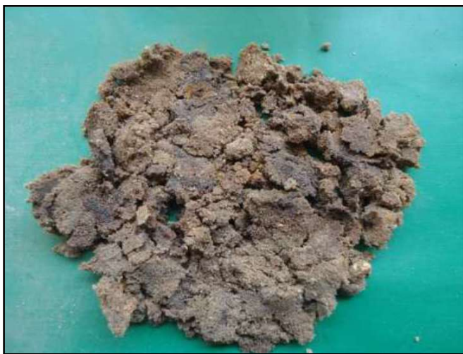
Figura 76. SP-04 Amostra 05/09 – Profundidade: 2,00 a 2,45m Classificação do Material: Areia fina, pouco argilosa, fofa, de cor cinza e marrom. (Fonte: PCA Engenharia, 2018).
