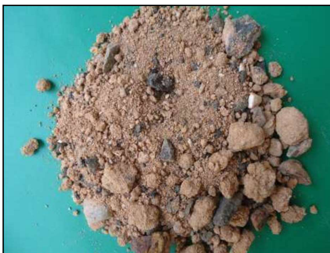
Figura 66: SP-03 Amostra 02/07 – Profundidade: 0,06 a 0,67m Classificação do Material: Silte arenoso, com pedriscos e pedras de seixo de cor marrom pouco claro. (Fonte: PCA Engenharia, 2018).
