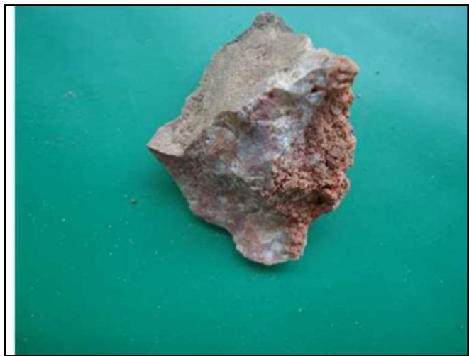
Figura 55. SP-01 Amostra 02/05 – Profundidade: 0,04 a 0,11m Classificação do Material: Pedra de Calçamento. (Fonte: PCA Engenharia, 2018).
