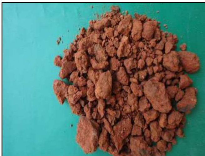
Figura 71. SP-03 Amostra 07/07 – Profundidade: 5,00 a 5,45m Classificação do Material: Silte areno- argiloso, compacto, com pedregulho de laterita miúda, de cor vermelho. (Fonte: PCA Engenharia, 2018).
