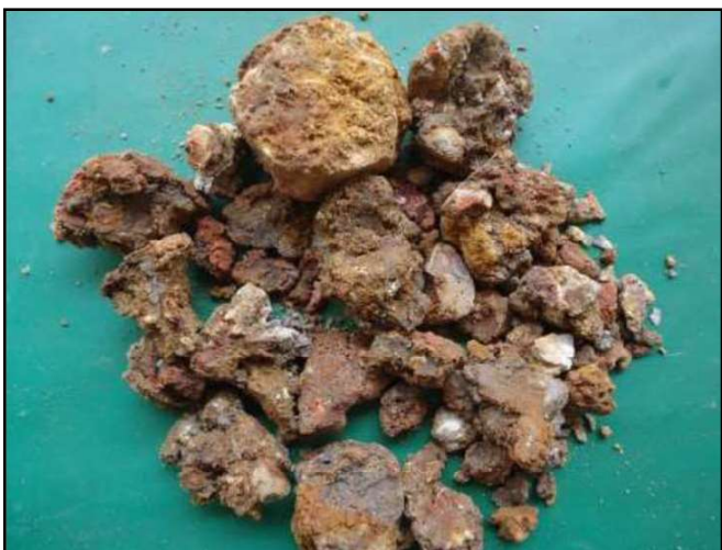
Figura 78. SP-04 Amostra 08/09 – Profundidade: 5,00 a 5,45m Classificação do Material: Silte, pouco argiloso, compacto, de cor roxa, com veios brancos. (Fonte: PCA Engenharia, 2018).
