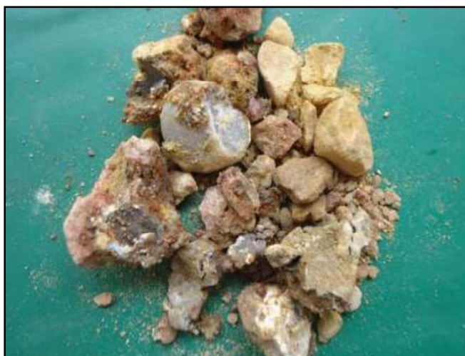
Figura 80. SP-04 Amostra 09/09 – Profundidade: 6,00 a 6,45m Classificação do Material: Silte, pouco argiloso, compacto, de cor roxa, com veios brancos. (Fonte: PCA Engenharia, 2018).
