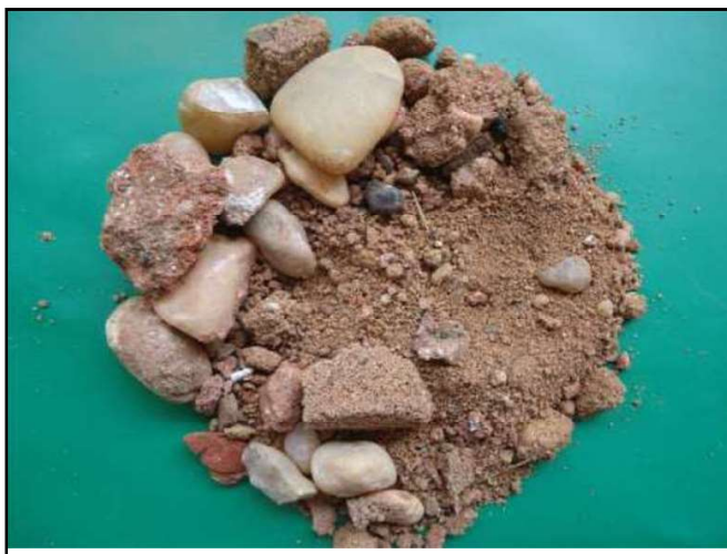
Figura 56. SP-01 Amostra 03/05 – Profundidade: 0,11 a 0,40m Classificação do Material: Silte arenoso, com pedras de seixo, e resto de material de demolição, de cor marrom. (Fonte: PCA Engenharia, 2018).
