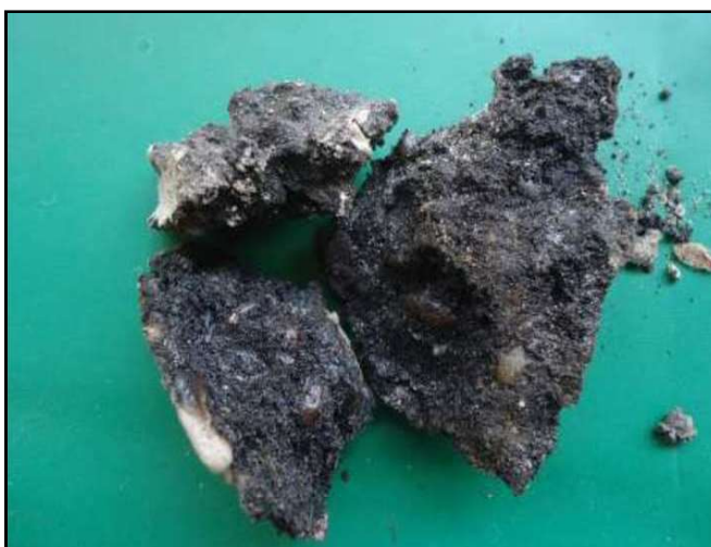
Figura 72. SP-04 Amostra 01/09 – Profundidade: 0,00 a 0,02m Classificação do Material: Asfalto. (Fonte: PCA Engenharia, 2018).
