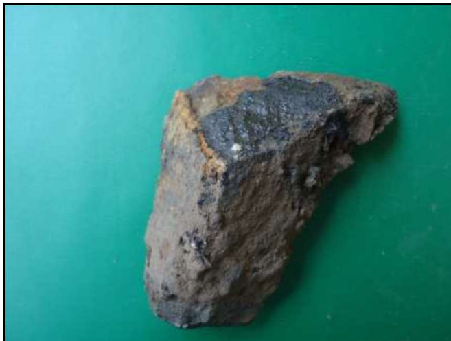
Figura 65: SP-03 Amostra 01/07 – Profundidade: 0,00 a 0,06m Classificação do Material: Pedra de Calçamento. (Fonte: PCA Engenharia, 2018).
