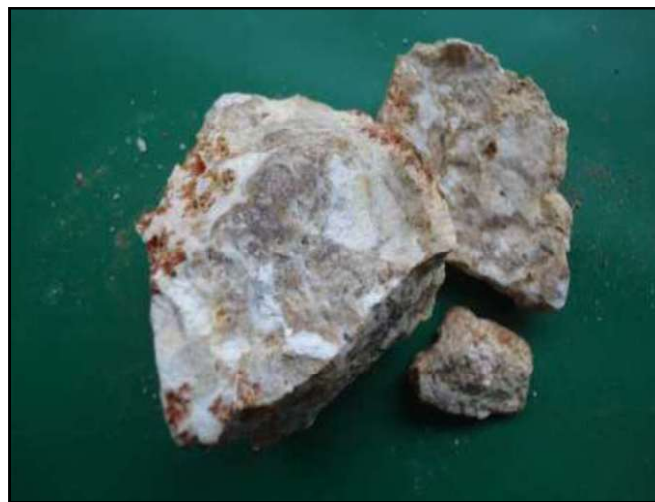
Figura 73. SP-04 Amostra 02/09 – Profundidade: 0,02 a 0,09m Classificação do Material: Pedra de Calçamento. (Fonte: PCA Engenharia, 2018).
