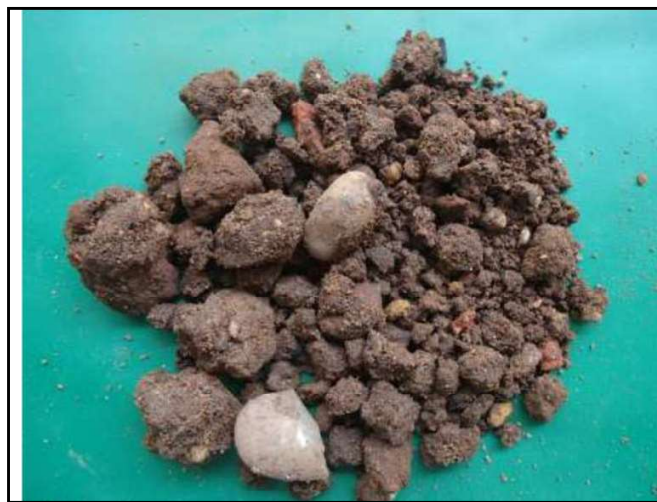
Figura 61: SP-02 Amostra 03/06 – Profundidade: 0,10 a 0,52m Classificação do Material: Silte arenoso, com pedras de seixo, e resto de material de demolição, de cor marrom. (Fonte: PCA Engenharia, 2018).
