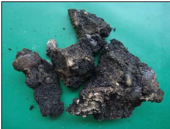
Figura 59: SP-02 Amostra 01/06 – Profundidade: 0,00 a 0,03m Classificação do Material: Asfalto. (Fonte: PCA Engenharia, 2018).
