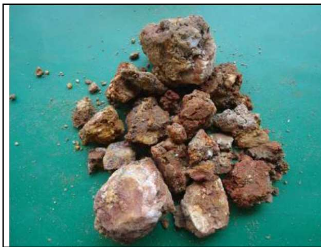
Figura 79. SP-04 Amostra 07/09 – Profundidade: 4,00 a 4,45m Classificação do Material: Silte, pouco argiloso, compacto, de cor roxa, com veios brancos. (Fonte: PCA Engenharia, 2018).
