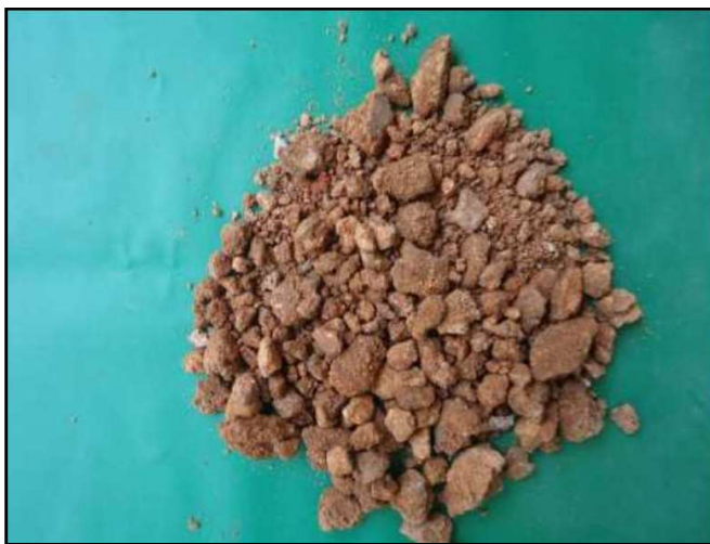
Figura 70. SP-03 Amostra 06/07 – Profundidade: 4,00 a 4,45m Classificação do Material: Silte arenoso, pouco argiloso, medianamente compacto, com pedriscos de seixo, de cor marrom. (Fonte: PCA Engenharia, 2018).
