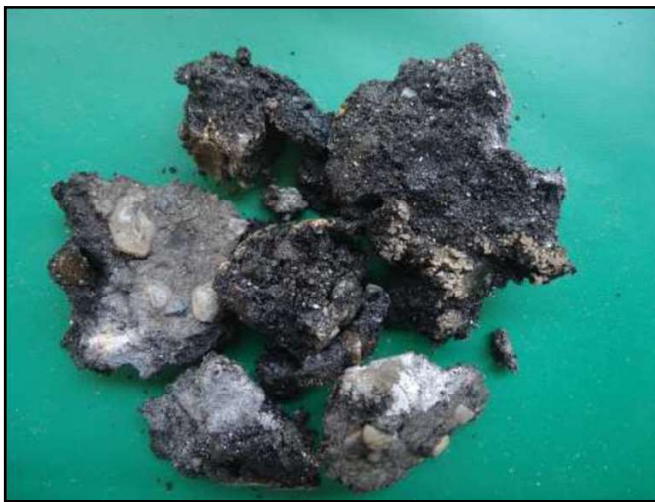
Figura 54. SP-01 Amostra 01/05 – Profundidade: 0,00 a 0,04m Classificação do Material: Asfalto. (Fonte: PCA Engenharia, 2018).
