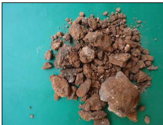
Figura 69: SP-03 Amostra 05/07 – Profundidade: 3,00 a 3,45m Classificação do Material: Silte arenoso, pouco argiloso, medianamente com pacto, com pedriscos de seixo, de cor marrom. (Fonte: PCA Engenharia, 2018).
