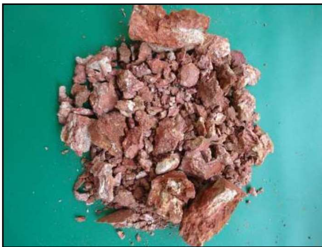
Figura 58: SP-01 Amostra 05/05 – Profundidade: 2,00 a 2,45m Classificação do Material: Silte argiloso, pouco arenoso, duro, com intercalação de lateritas friáveis, de cor variegada com predominância vermelho. (Fonte: PCA Engenharia, 2018).
