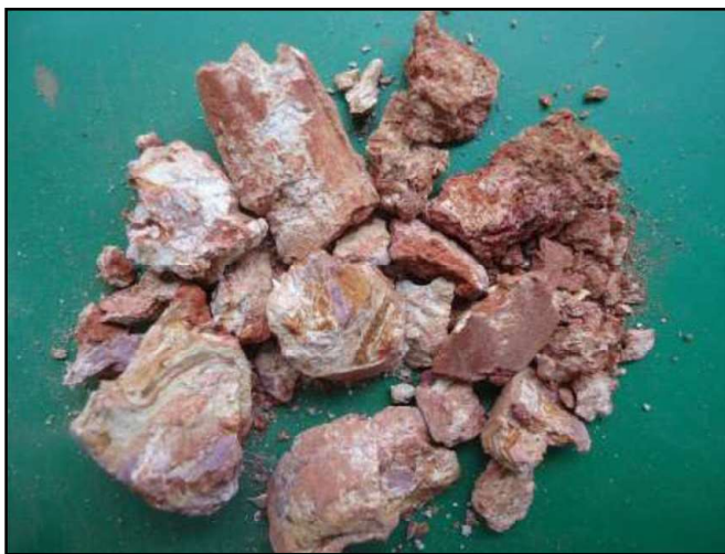
Figura 64: SP-02 Amostra 06/06 – Profundidade: 3,00 a 3,12m Classificação do Material: Silte argiloso, duro, com intercalação de areia, e lateritas friáveis, de cor variegado. (Fonte: PCA Engenharia, 2018).
