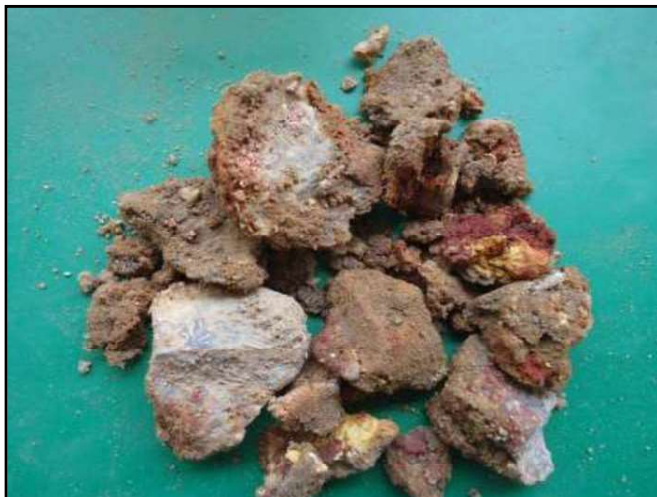
Figura 77. SP-04 Amostra 06/09 – Profundidade: 3,00 a 3,45m Classificação do Material: Silte areno- argiloso, fofo a compacto, com fragmentos de pedras de mão, de quartzo, (Fonte: PCA Engenharia, 2018).
