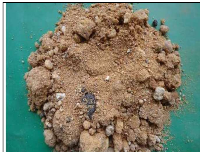
Figura 74. SP-04 Amostra 03/09 – Profundidade: 0,09 a 0,77m Classificação do Material: Silte arenoso, com pedriscos e pedras de seixo de cor marrom. (Fonte: PCA Engenharia, 2018).
