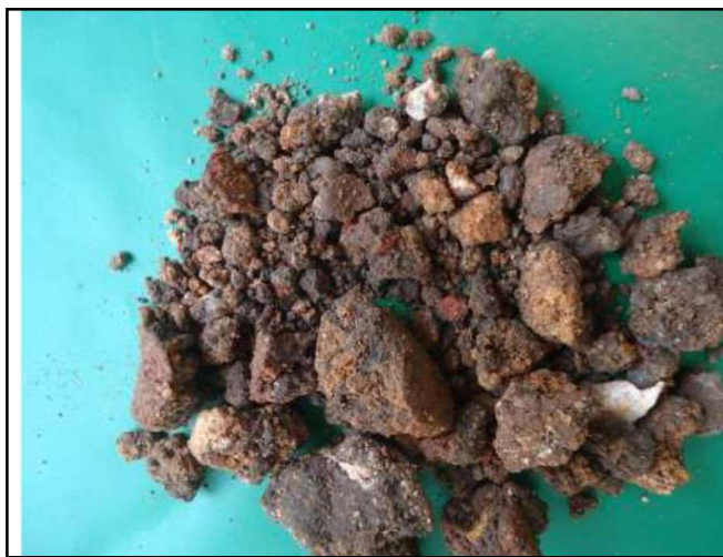
Figura 67: SP-03 Amostra 03/07 – Profundidade: 1,00 a 1,45m Classificação do Material: Silte arenoso, pouco a medianamente argiloso, medianamente compacto, com pedaços de pedras, de cor pouco escuro. (Fonte: PCA Engenharia, 2018).
