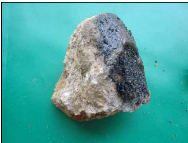
Figura 60: SP-02 Amostra 02/06 – Profundidade: 0,03 a 0,10m Classificação do Material: Pedra de Calçamento. (Fonte: PCA Engenharia, 2018).
