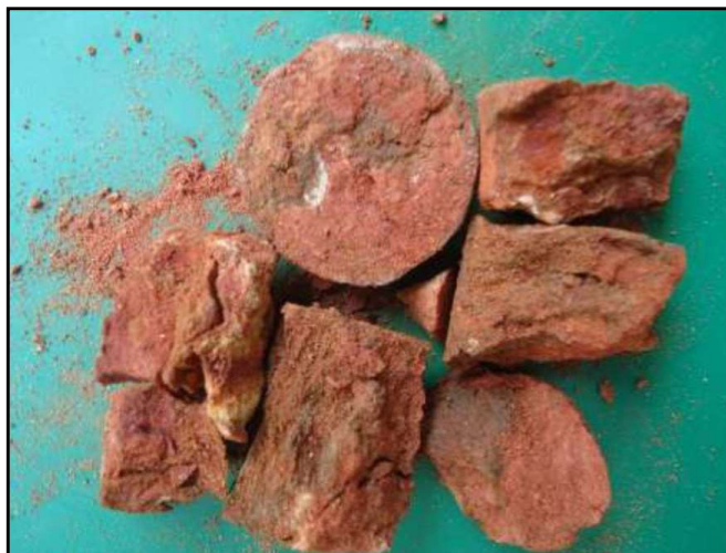
Figura 63: SP-02 Amostra 05/06 – Profundidade: 2,00 a 2,45m Classificação do Material: Silte arenoso, pouco a medianamente argiloso, medianamente a compacto, de cor variegado com predominância avermelhado. (Fonte: PCA Engenharia, 2018).
