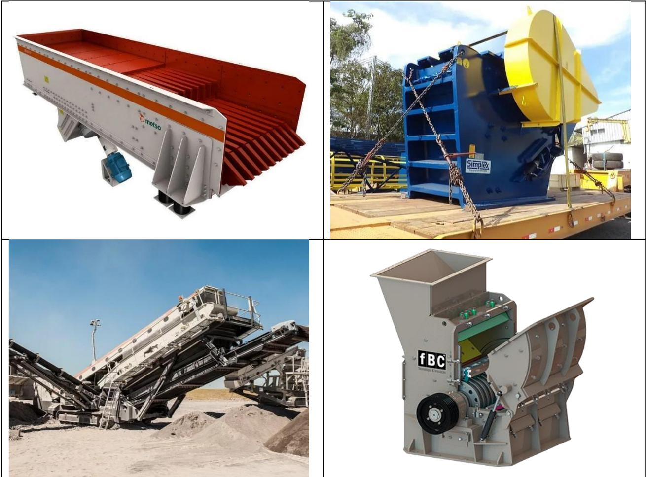
Figura 16. Alimentador vibratório (A), Britador primário (B), Peneira vibratória (C), Moinho de martelo (D).
