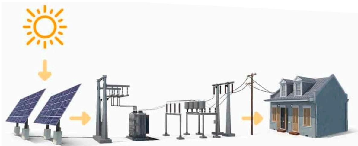
A energia do sol vai para as placas fotovoltaicas que transformam essa energia em corrente contínua, então uma série de equipamentos transformam essa corrente contínua em corrente alternada, que é aquela que utilizamos em nossas casas. Então o sistema de transmissão de energia, leva essa energia produzida na usina para nossas casas. Energia limpa e renovável, já que o sol é uma fonte de energia que podemos considerar infinita.
