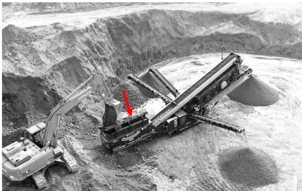
Figura 18: Exemplo de silo de abastecimento do circuito de peneiramento móvel.
