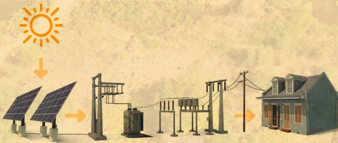
A energia do sol vai para as placas fotovoltaicas que transformam essa energia em corrente contínua, então uma série de equipamentos transformam essa corrente contínua em corrente alternada, que é aquela que utilizamos em nossas casas. Então o sistema de transmissão de energia, leva essa energia produzida na usina para nossas casas. Energia limpa e renovável, já que o sol é uma fonte de energia que podemos considerar infinita.
